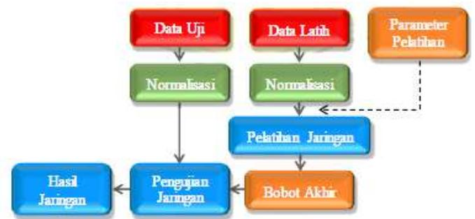
Gambar 2. Alur pelatihan dan pengujian *backpropagation*
