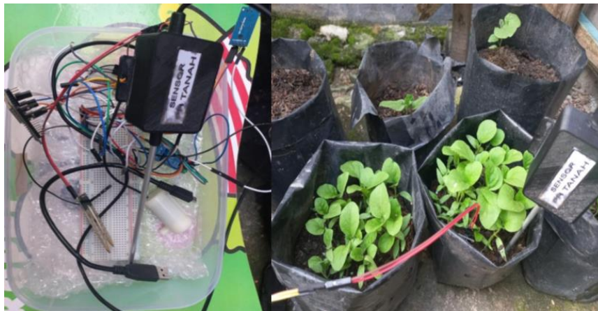
Gambar 5 Perangkat Sensor,MCU dan Media Tanam
