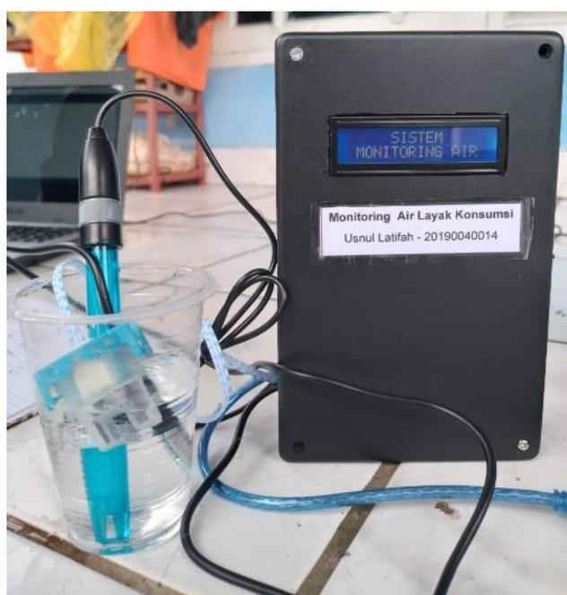
Gambar 11. Pemasangan Cashing Pada Alat
