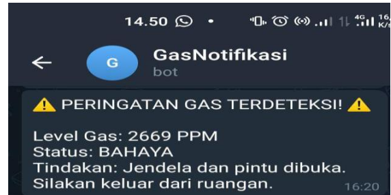
Gambar 7(a). Tampilan web monitoring untuk status Bahaya ( > 2000 PPM) Gambar 7(b). Tampilan notifikasi telegram untuk status Bahaya ( > 2000 PPM)
