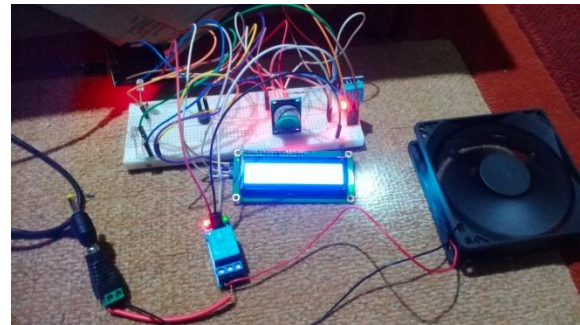
Gambar 2. Proses Perakitan Prototipe Sistem Smart Ventilation Berbasis IoT
