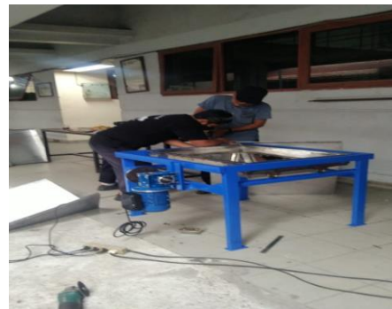
Gambar 4. Proses Pembuatan Modifikasi Mesin Pengayak
