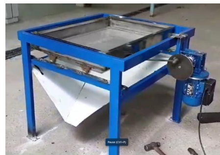
Gambar 5. Hasil Modifikasi Mesin Pengayak
