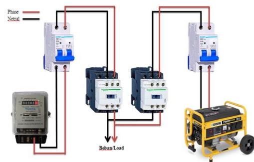
Gambar 5. Pengkabelan (Wiring) ATS.
