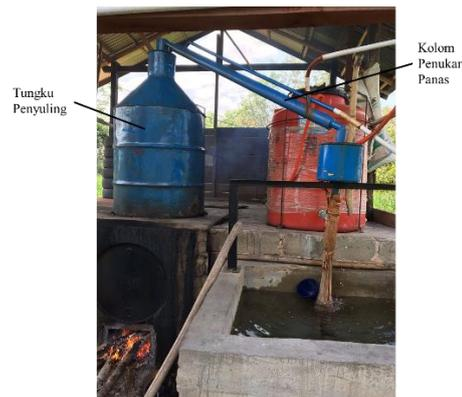
Gambar 1: Susunan Perangkat Penyulingan Lama
