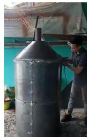
Gambar 3: Kegiatan Pengelasan Tangki Penyuling Baru
