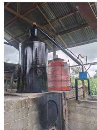
Gambar 2: Susunan Perangkat Penyulingan Baru
