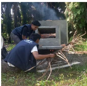
Gambar 2 Uji coba pembakaran sampah menggunakan rocket stove
