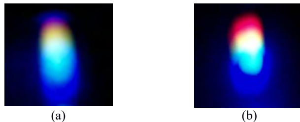
GAMBAR 4. HASIL VISUAL KISI (A) 300 LINE/MM ORDE 2 (B) 600 LINE/MM ORDE 1
