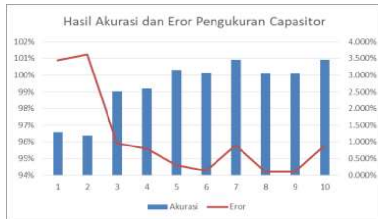
Gambar 9. Hasil Akurasi dan Eror Pengukuran Capasitor
