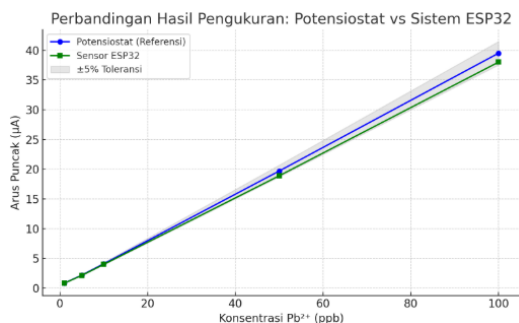
Gambar 3. Perbandingan hasil pengukuran : Potensiostat vs Sistem ESP32
