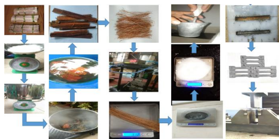
Gambar 1. Metode pembuatan serat hingga pengujian material komposit.
