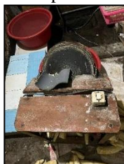
Gambar 5. Desain Mesin Pengiris Singkong Terdahulu
