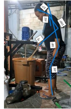
Gambar 8. Gerakan 3 (membending arus adonan agar tercampur rata)
