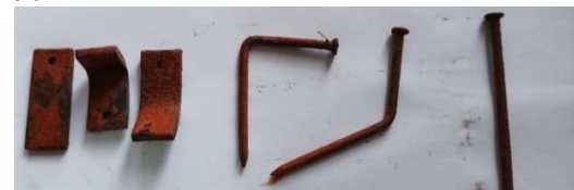
Gambar 2. Spesimen setelah perendaman air laut
