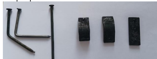
Gambar 4. Spesimen setelah perendaman air laut
