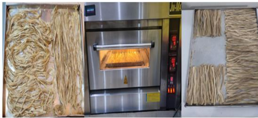
Gambar 3. Proses pengeringan serat Sisal
