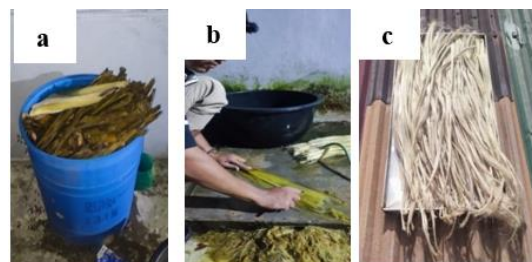
Gambar 1. Proses ekstraksi serat Sisal, (a) perendaman daun sisal, (b) pemisahan lapisan luar dengan serat, dan (c) serat sisal setelah diekstraksi
