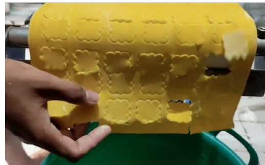
Gambar 8. Kualitas Hasil Pencetakan Krupuk Cassava Menggunakan Mesin
