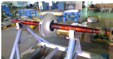
Gambar 11 Pengujian Liquid Penetrant Inspection Pada Impeller
