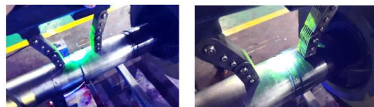
Gambar 9 Pengujian Magnetic Particle Inspection Pada Poros
