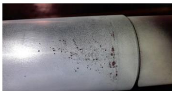
Gambar 12 Pengujian Liquid Penetrant Inspection Pada Poros
