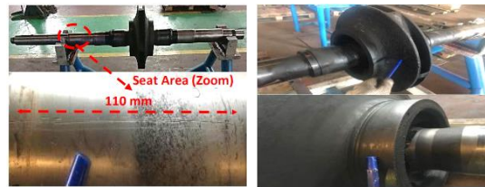
Gambar 8 Pengujian Visual Inspection Pada Impeller dan Poros
