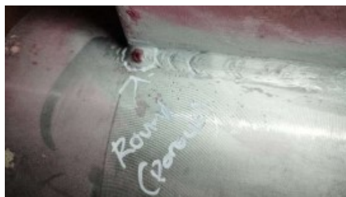
Gambar 8. Indikasi bulat khas pada spider riser pipe 1
