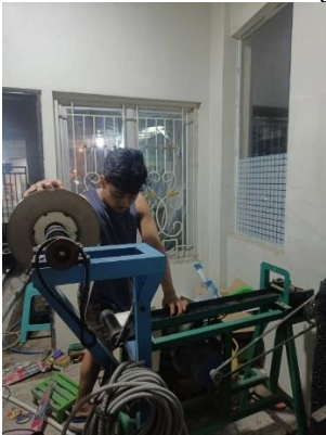
Gambar 7. Uji Coba Mesin Pencetak Lidah Rokok
