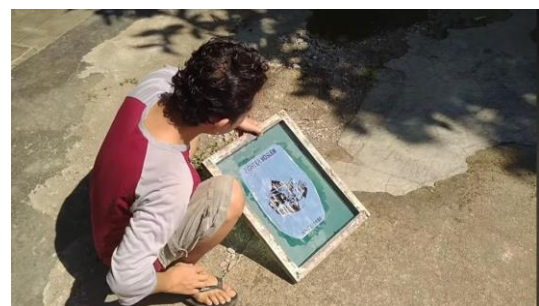
Gambar 4. Penyinaran Frame Screen Dengan Sinar UV Matahari
