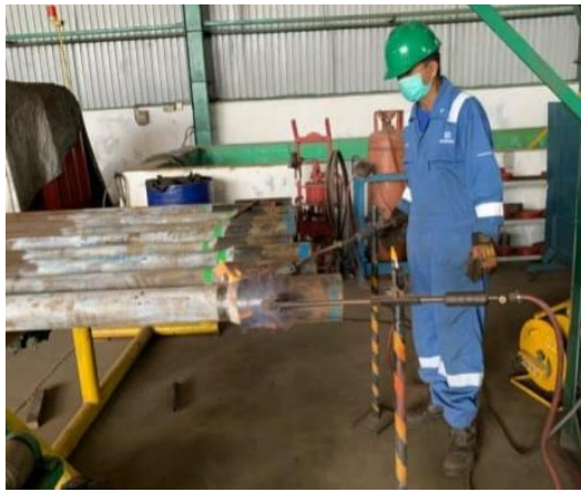
Gambar 1. Pengelasan ulir pipa
