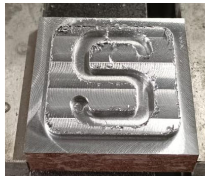
Gambar 7. Pengerjaan S-Slot menggunakan perintah Countour
