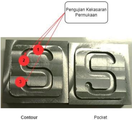
Gambar 10. Hasil Proses Manufaktur Menggunakan Perintah Contour dan Pocket
