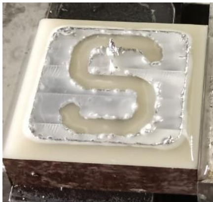
Gambar 8. Pengerjaan S-Slot menggunakan perintah Pocket
