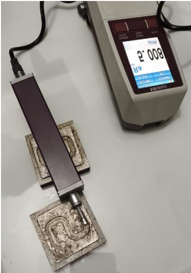
Gambar 10. Pengukuran kekasaran permukaan menggunakan Surface Roughness Tester
