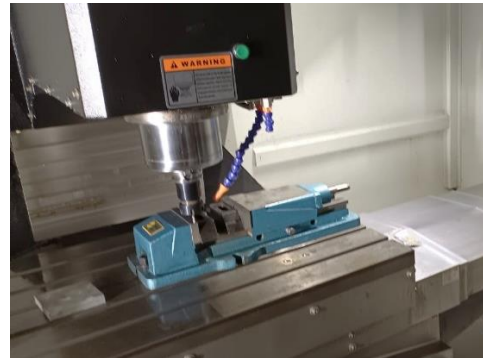
Gambar 6. Pengaturan Zero Point dan perataan Benda Kerja
