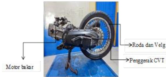
Gambar 13. Penggerak sepeda motor berbahan bakar fuel
