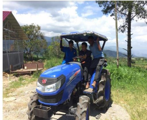
Gambar 1. Traktor Roda Empat Jenis Iseki AT 5470
