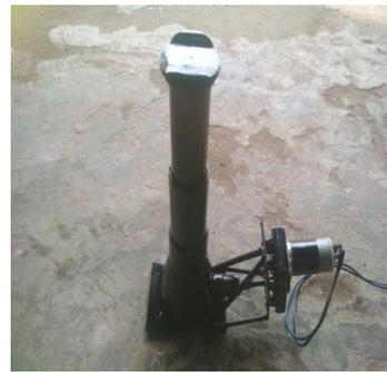
Gambar 6. Pengujian dongkrak ulir tanpa beban
