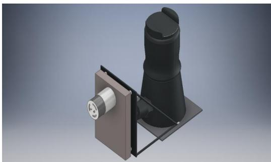
Gambar 2. Dongkrak ulir botol elektrik tampak depan
