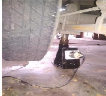
**Gambar 8.** Pengujian berbeban pada roda belakang. Hasil pengujian dongkrak ulir botol elektrik pada roda belakang saat diberi beban disajikan pada tabel 3.
