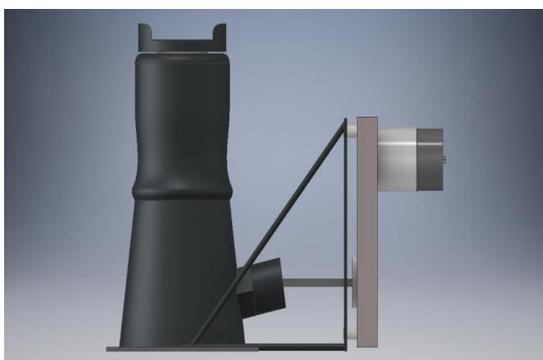
Gambar 3. Dongkrak ulir botol elektrik tampak samping
