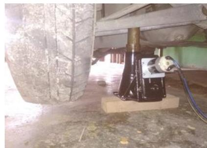
Gambar 7. Pengujian dongkrak ulir saat diberi beban pada roda depan
