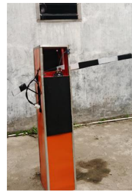
Gambar 3. Hasil rancang ulang portal otomatis berbasis ESP32 dengan sensor ultrasonik HC-SR04
