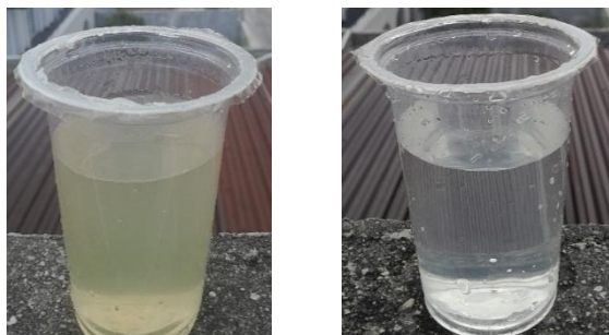
Gambar 3. Air Baku (Inlet) dan Air Hasil Olahan (Outlet)
