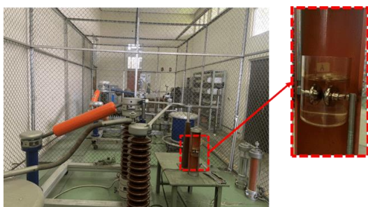
Gambar 3. Tampilan skematis uji tegangan breakdown
