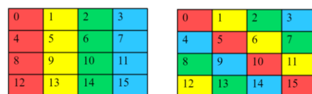
(a). Satu round ganjil (kolom) (b). Satu round genap (diagonal) Gambar 4 Double Round [1]
