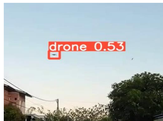
Gambar 7. Hasil Deteksi Bisa Membedakan Drone Dengan Burung
