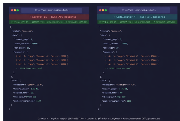
Gambar 4. Tampilan Respons JSON REST API - Laravel 11 (kiri) dan CodeIgniter 4 (kanan) pada Endpoint GET /api/products
