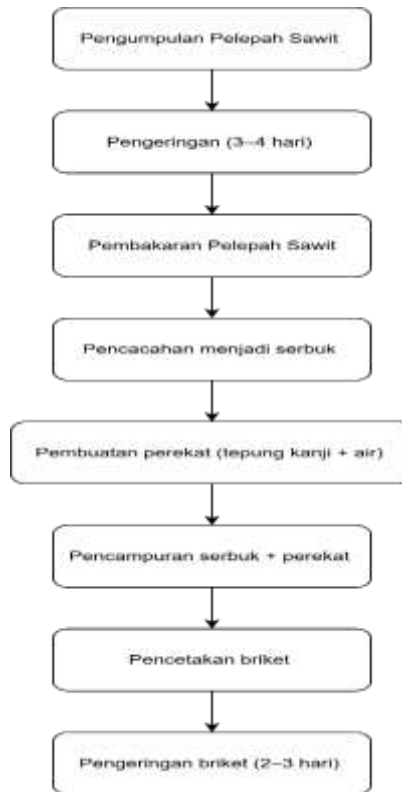
Gambar 2. Alur Proses Produksi Briket Pelepah Sawit
