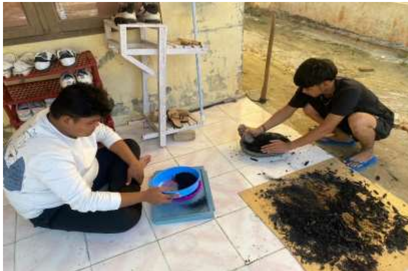
Gambar 3. Proses pencacahan arang pelepah sawit sebelum dicampur dengan perekat
