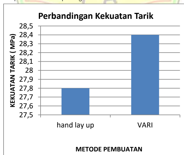
Gambar 2. Perbandingan kekuatan tarik menggunakan metode hand lay up dan VARI.
